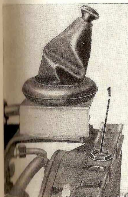
Obraz 57a (1) Trychtýř (2) Čidlo teploměru
