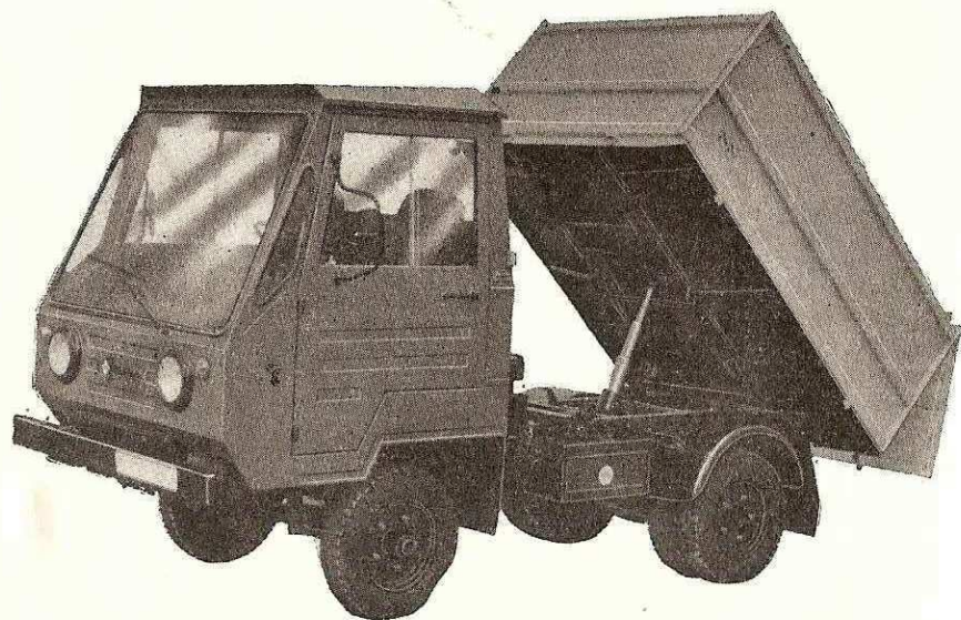
Obraz 83. Sklápěčkový automobil sklopný dozadu M 2512
